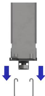
1) Baje la brida a través del orificio en el canal.
