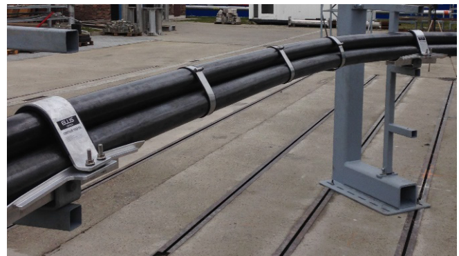
UNE PHOTO DU BANC D'ESSAI DE COURT-CIRCUIT POUR LE CENTAUR TREFOIL. LES ESSAIS ONT ÉTÉ MENÉS DANS LES LABORATOIRES ZKU À PRAGUE, EN RÉPUBLIQUE TCHÈQUE.
