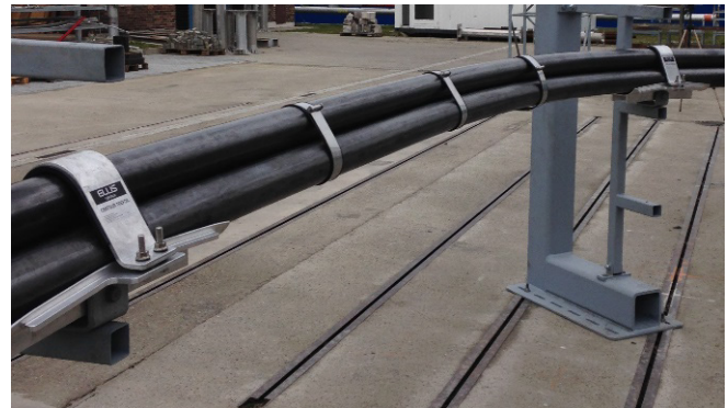
FOTO DEL APAREJO DE PRUEBA DE CORTOCIRCUITO PARA CENTAUR TREFOIL. LA PRUEBA SE LLEVÓ A CABO EN LOS LABORATORIOS ZKU DE PRAGA, REPÚBLICA CHECA.
