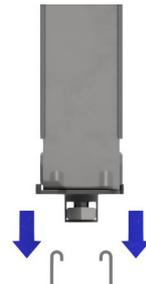
1) Baje la brida a través del orificio en el canal.
