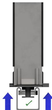
4) Conforme os parafusos forem apertados, as roscas de canal irão mover para cima da base giratória e aderir ao canal.
