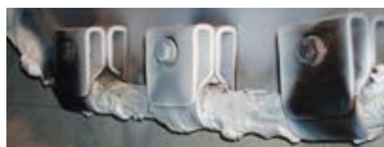
Phoenix-Halterungen werden in Übereinstimmung mit BS 8491 und BS 5839-1 hinsichtlich ihres Brandverhaltens geprüft.
