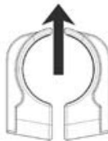
CHARGE LATÉRALE DIRECTION 'HORIZONTALE'
