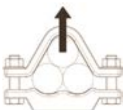
SEITENBELASTUNG „VERTIKALE“ RICHTUNG
