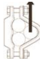
CHARGE LATÉRALE DIRECTION 'HORIZONTALE'
