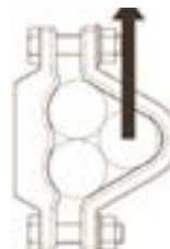
CARGA LATERAL 'DIRECCIÓN HORIZONTAL'
