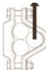
CHARGE LATÉRALE DIRECTION 'HORIZONTALE'
